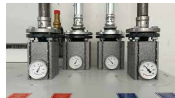
Thermisch hoch belastbar: die Installationskomponenten von „Megapress S“, hier die Flansche links und rechts, sind dafür mit FKM-Dichtelementen ausgestattet.
