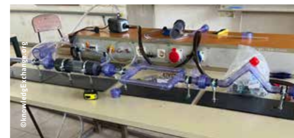
Aufbau eines Lehr-experiments zur Veranschaulichung von Druckverlusten in Rohrleitungen.
