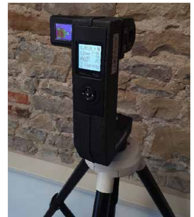
Abbildung 1: Das Ergebnis einer fünfjährigen Forschungsarbeit ist der piXplorer IR25, ein 360° Thermografiepanoramakopf, der geometrisch kalibrierte Thermografieaufnahmen als Kugelpanoramen mit 25 Millionen Pixeln aufnimmt. Dadurch werden erstmals sämtliche Energieverluste in einem sogenannten „übergeordneten Koordinatensystem“ lokalisiert, in geometrische und thermografische Relation zueinander gebracht und sind so einfacher identifizierbar und bewertbar.
