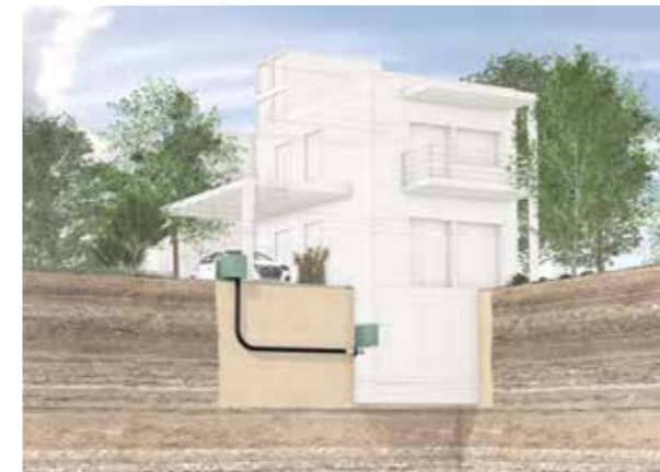
Neben der Wahl der richtigen Wärmepumpe ist die Wahl der korrekten Hauseinführung für die Wärmepumpe essentiell. Ansonsten ist die regelkonforme Abdichtung der die Kellerwand/die Bodenplatte durchdringenden Leitungen nicht sichergestellt.
