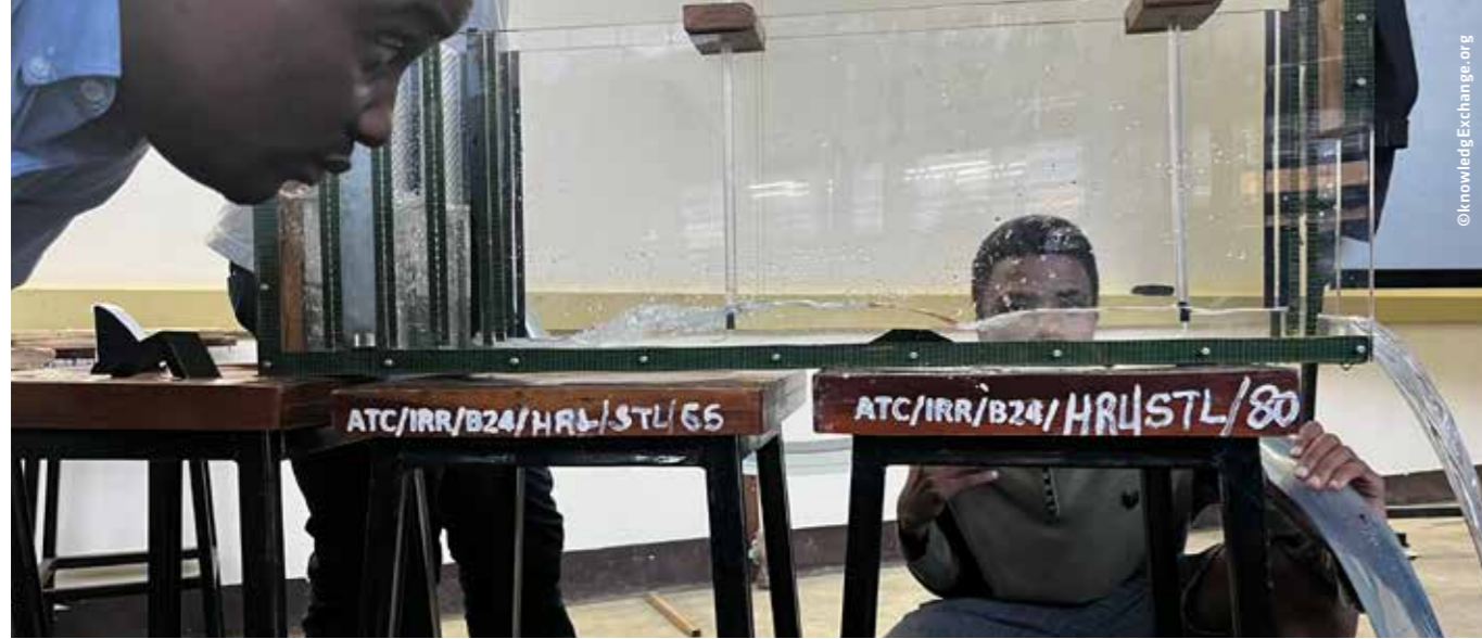
Kleines, kostengünstiges und transportables Laborgerinne zur Veranschaulichung von Freispiegelströmungen.
